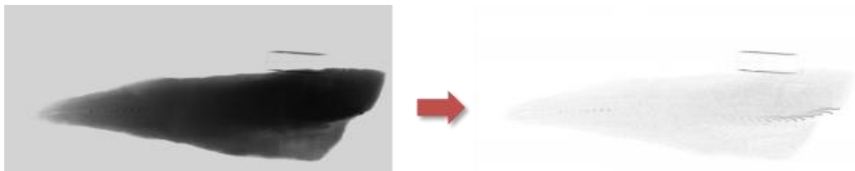
Figur 23. Figur som viser prosessering for å fremheve bein. Originalbilde fra røntgenmaskin til venstre og prosessert bilde til høyre.
